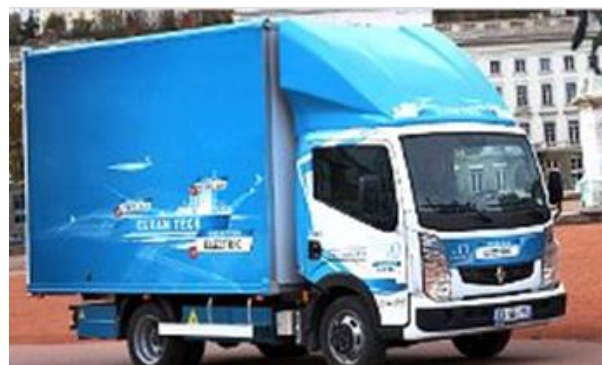
Véhicule distribution 4,5T Motorisation tout électrique 47 kW
