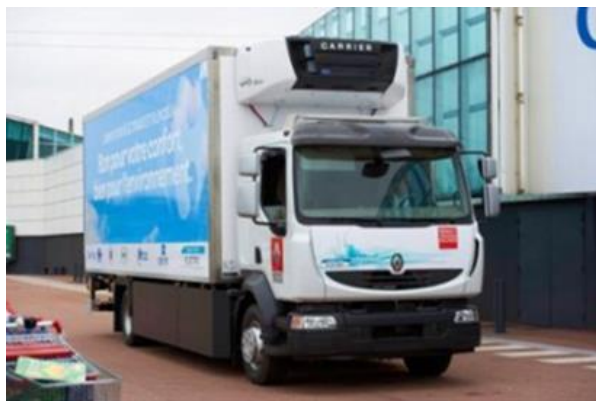
Véhicule distribution 10-16T Motorisation hybride série 103 kW Traction assurée par énergie électrique. Chargement des batteries par moteur thermique.
