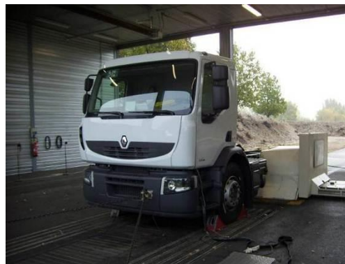
Véhicule distribution 16-26T Motorisation hybride parallèle 225 kW Traction assurée par énergie électrique seule (mode silencieux pour v < 20 km/h) ou couplage avec moteur thermique.
