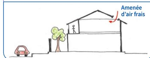
Avec une VMC double flux, on éloignera le plus possible l'amenée d'air frais de la route. Si nécessaire, on équipera le système d'un filtre (classe de filtration F7 minimum).
