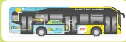
**Namur (Belgique) :** À Namur, 11 autobus hybrides “zéro émissions” circulent sur le réseau urbain exploité par l’entreprise TEC<sup>139</sup>. Ce nouveau type de véhicule hybride a la capacité de basculer en mode 100 % électrique dans les zones “cœurs de ville” pour une courte distance (4 à 5 km). Le passage en mode électrique est géré par l’ordinateur de bord sur la base de la localisation GPS et de l’autonomie des batteries.
