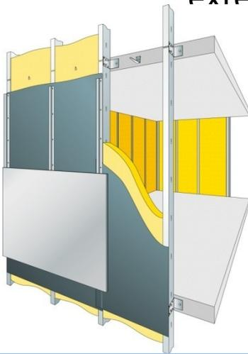
Pose d'un bardage sur les profilés interface-bardage
