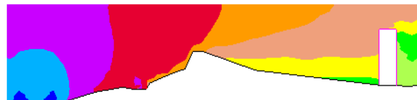
Réhausse de l'écran existant de 2 à 4m
