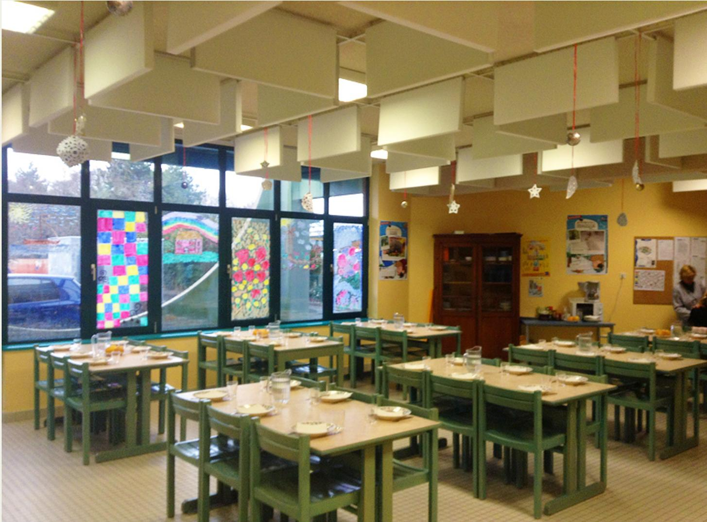
Dans ce restaurant de 100 m<sup>2</sup> environ, le plafond a été équipé de baffles acoustiques qui limitent l'effet de résonance.
