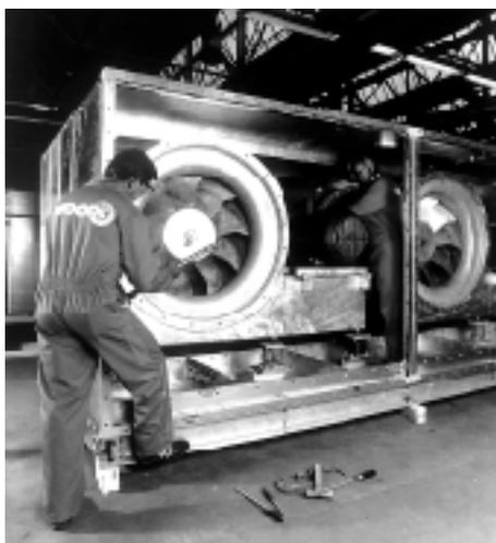
Fig. 6 : les ventilateurs à double flux Axcent 2 installés dans une unité de traitement d'air.
