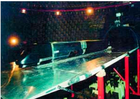
Fig. 4: Maquette de TGV au 1/7° dans la soufflerie anéchoïque Cepra19
