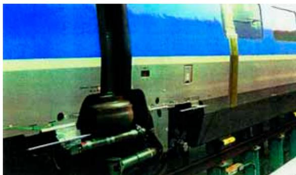
Fig. 6: Essais en ligne à l'aide de sondes embarquées
