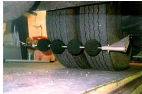
Photo 2 : Antennes de mesure
