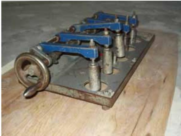
Fig. 1 : Le 'batter de plancher', invention géniale qui permet de reproduire les mesures de l'absorption des bruits de pas (fonctionne aujourd'hui à l'électricité)
