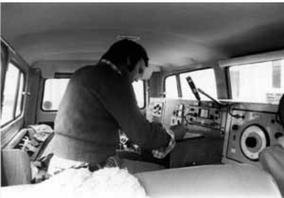
Fig. 4 : Voiture électro-technique équipée d'appareils de mesures analogues dans les années 70
