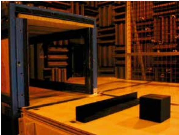
Fig. 7 : Cube et barrette sur plancher réfléchissant dans la soufflerie de l'Ecole Centrale de Lyon
