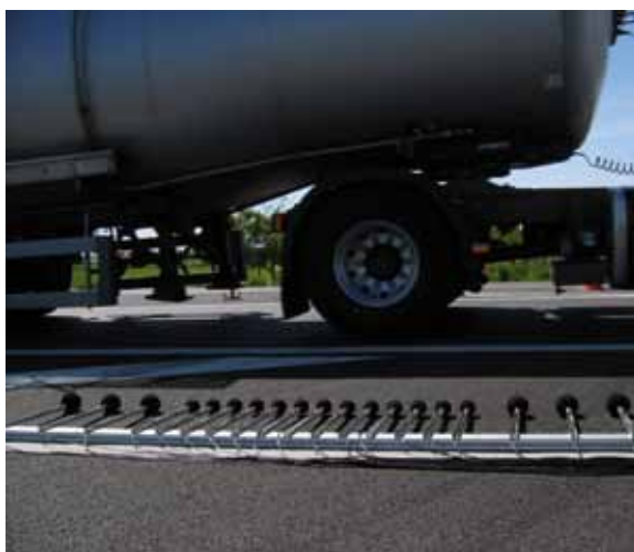
Fig. 2 : Antenne microphonique horizontale pour la caractérisation des sources des PL au passage
