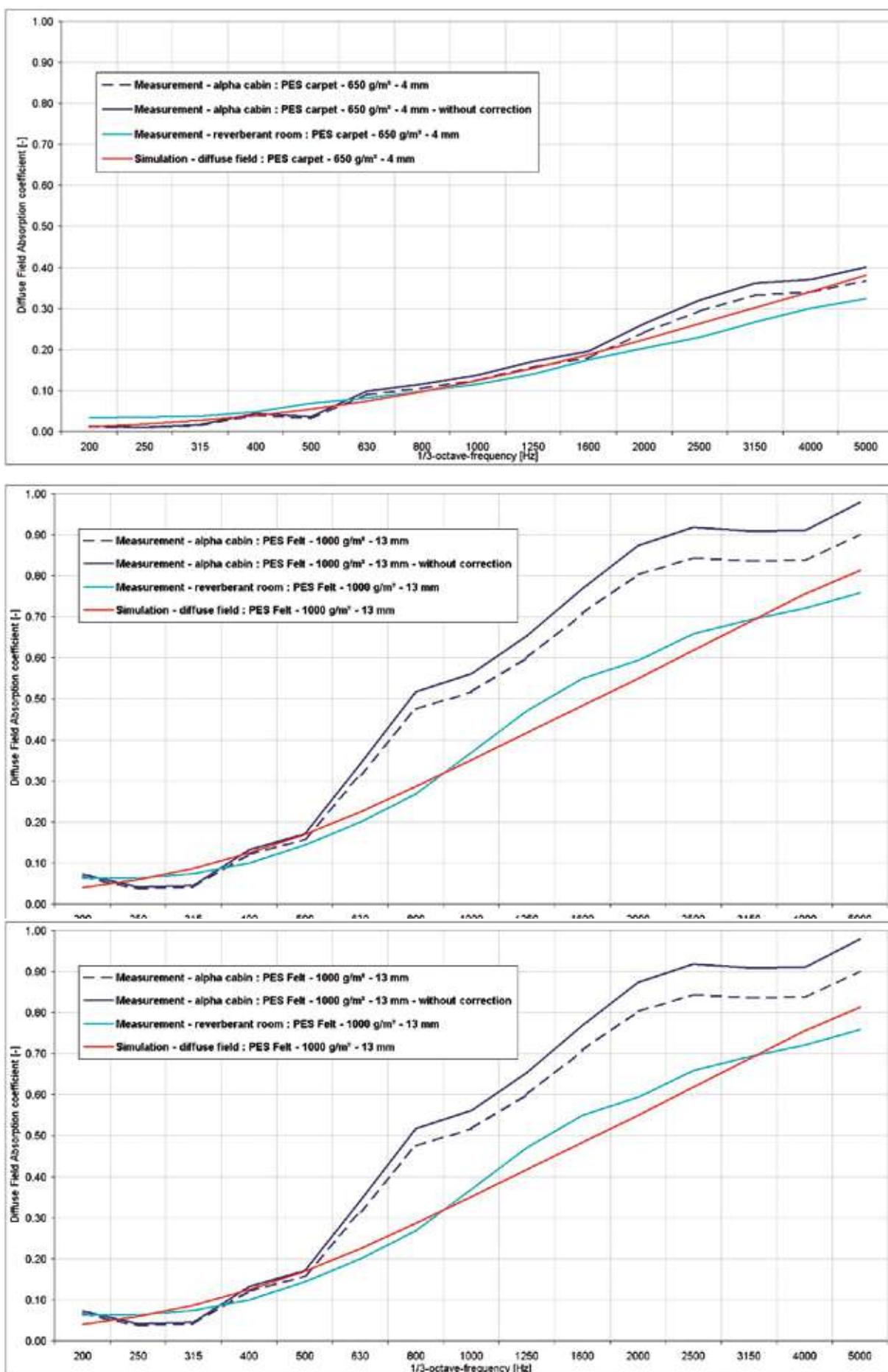
Fig. 13 à 15 : Random incidence absorption coefficient : measurement versus simulation
