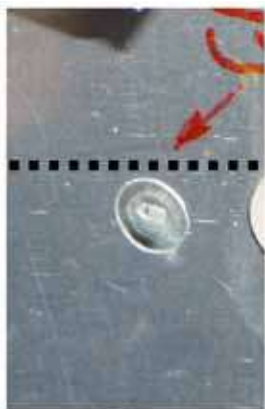
Fig. 10: Résultats d'une expérience RT, utilisant une analyse des fréquences d'intermodulation, pour une aile d'avion (à gauche) comportant une fissure localisée proche d'un rivet. Évolution (à droite) point par point du niveau d'intermodulation de fréquence dans le signal RT rétrofocalisé, en fonction de la distance de la fissure. Les fréquences appliquées sont 200 kHz and 1 MHz. Les signatures de l'intermodulation correspondent aux fréquences somme et différence dans le signal RT de rétrofocalisation
