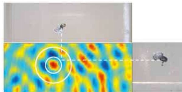
Fig. 9 : Résultats expérimentaux de la rétrofocalisation sur une zone dégradée d'un échantillon de verre PMMA, utilisant la procédure PC-PS de filtrage par inversion de pulse
