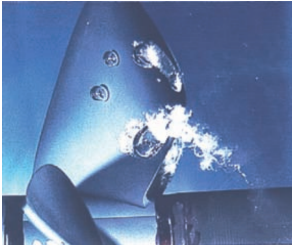
Fig. 5: Cavitation en bout de pale d'hélice. Photo: Bassin d'essais des carènes
