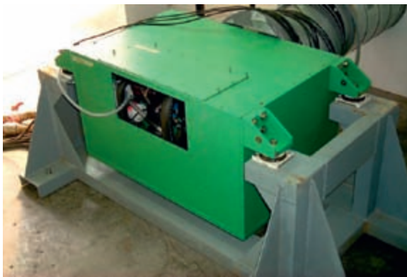
Fig. 10: Montage d'essais autour d'un climatiseur
