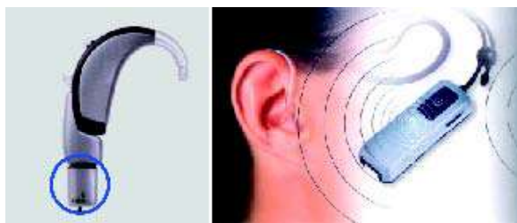
Fig. 35 : Principe de couplage d'un système HF sur entrée audio
