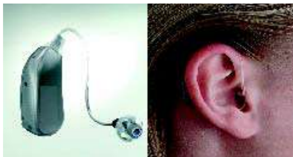
Fig. 5 : Aide auditive de type écouteur déporté
