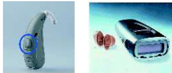
Fig. 34 : Contacteur et télécommande permettant de modifier les programmes
