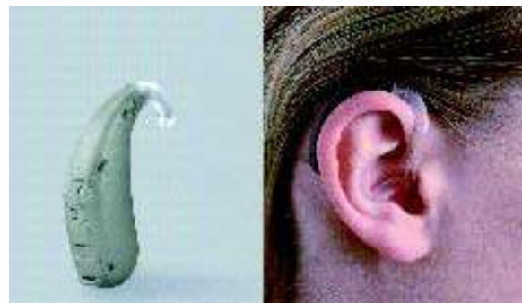
Fig. 3 : Aide auditive de type contour d'oreille
