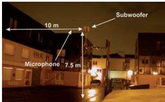
Fig. 10 : Mesure d'un caisson de basse en environnement urbain Subwoofer measurement set-up in urban area
