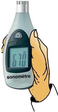
Le bruit s'enregistre et se mesure à l'aide d'un microphone dont la membrane vibre comme un tympan et fournit un courant électrique alternatif qui varie en volts comme la pression acoustique.
