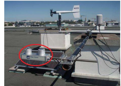
Capteur : Station météo, Pyranomètre, Pyrgeomètre, thermocouples, capteurs de teneurs en eau, capteurs flux thermiques, capteurs de précipitation
