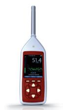
Capable de mesurer des niveaux supérieurs ou égaux à 30 dB(A), cet équipement donne des résultats avec une incertitude faible au regard de l'échelle de l'évaluation.
