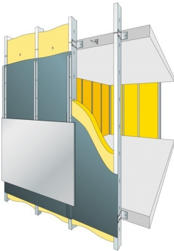
Pose d'un bardage sur les profilés interface-bardage
