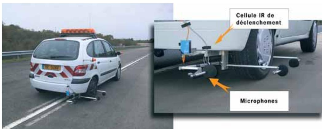
Fig. 5 : Véhicule instrumenté et détails du montage des capteurs
