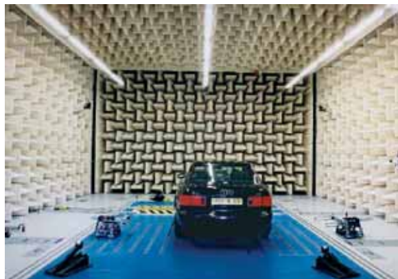
Fig. 4 : Chambre semi-anéchoïque Michelin
