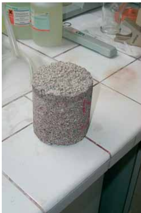
Photo 3 : Béton de pouzzolane vieilli + pollué
