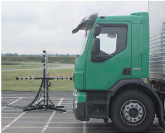
Fig. 3 : Antenne en croix constituée de 41 microphones 41-microphone cross-array
