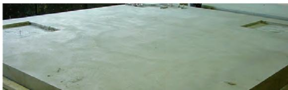
Fig. 1: Plancher d'essai en béton armé de 180 mm
