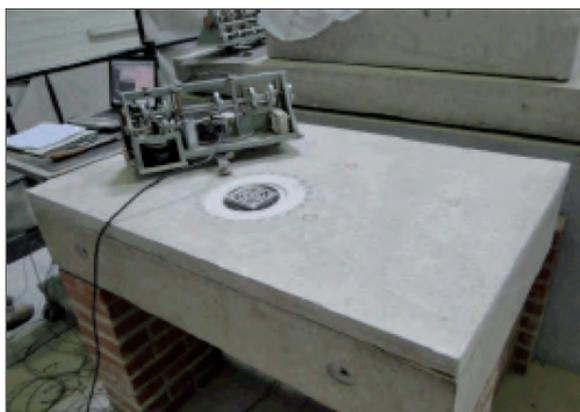
Fig. 11 : Photo du banc d'essai pr ISO 16251-1 adapté pour l'intégration d'un siphon de sol
