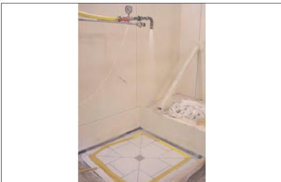
**Fig. 3 : Dispositif d'essai pour le bruit du jet d'eau (GEB à 2 m orienté vers le centre de la douche)**
