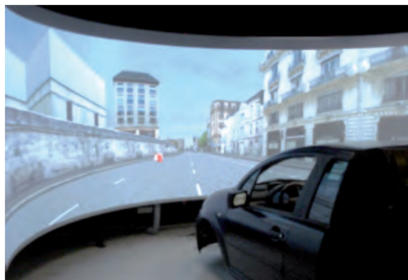
Fig. 1 : Simulateur de conduite utilisé pour l'étude Picture of the driving simulator used for the study
