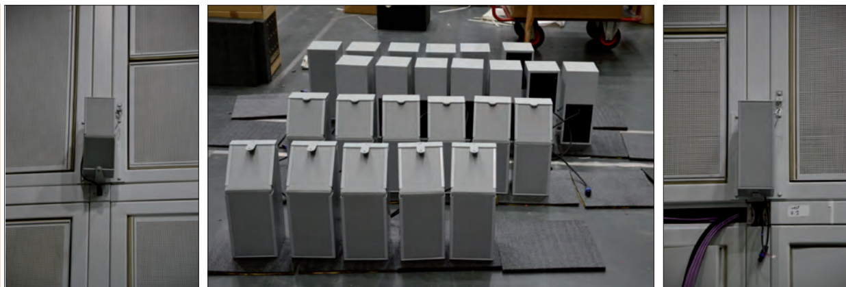
Fig. 7 : Différentes versions des haut-parleurs PMX5-SLIM utilisés pour l'hémisphère de diffusion en mode HOA. Les versions diffèrent par l'inclinaison des pavillons de sorte à orienter le lobe principal vers le centre de la salle
