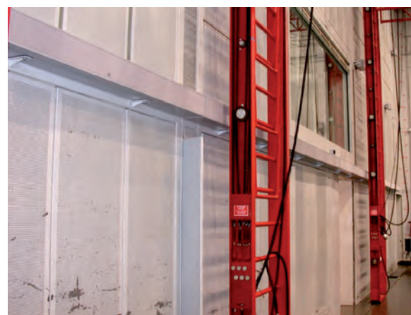
Fig. 5 : Segment frontal (scène) et segment latéral du réseau de haut-parleurs pour la WFS
