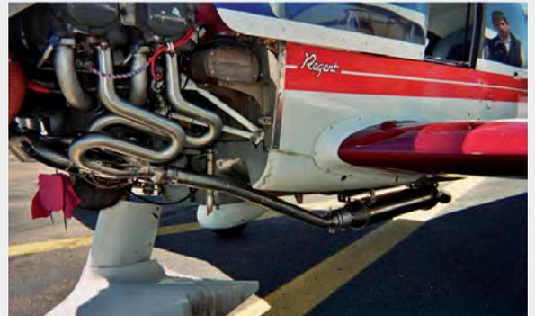
**APEX AIRCRAFT DR400-180 équipé du silencieux d'échappement accordé double flux en inox « SCAI-TECH »**
