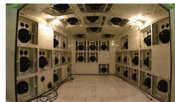
Fig. 15 : Intérieur de la cabine et système d'excitation
