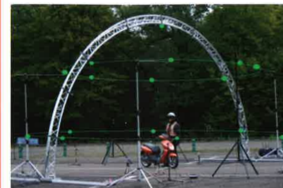
Fig. 2 : Système de mesure de puissance et de directivité acoustiques
