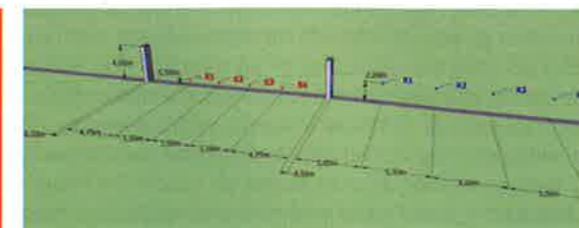
Fig. 5 : Configuration des simulations TLM avec double écran
