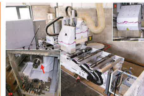
Fig. 1 : Centre d'usinage Homag-Weeke BHC 550. Les principales sources de bruit sont : A : La tête d'usinage ; B : La table avec système de serrage pneumatique ; C : La pompe à vide. En haut à droite (X) : Gros plan de la tête d'usinage ; en bas à gauche (XX) : intérieur de la tête d'usinage (la système broche-moteur est montré par une flèche)
