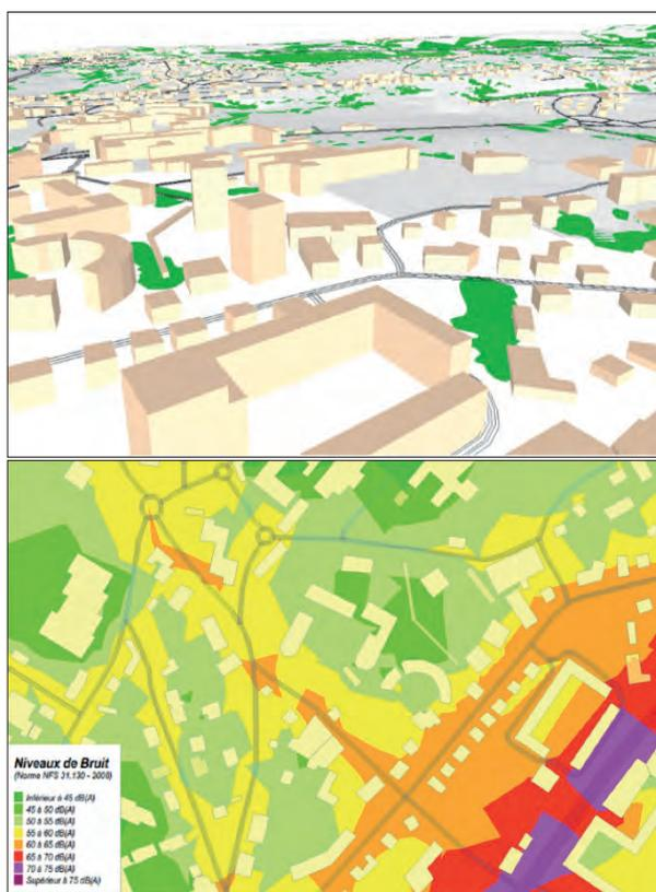
Fig. 2 : Construction d'un modèle de prédiction du bruit dans l'environnement : Représentation 3D de la Ville de Besançon (topographie, bâtis, voies de circulation routières et ferroviaires) et carte de bruit (Logiciel MITHRA-SIG)
