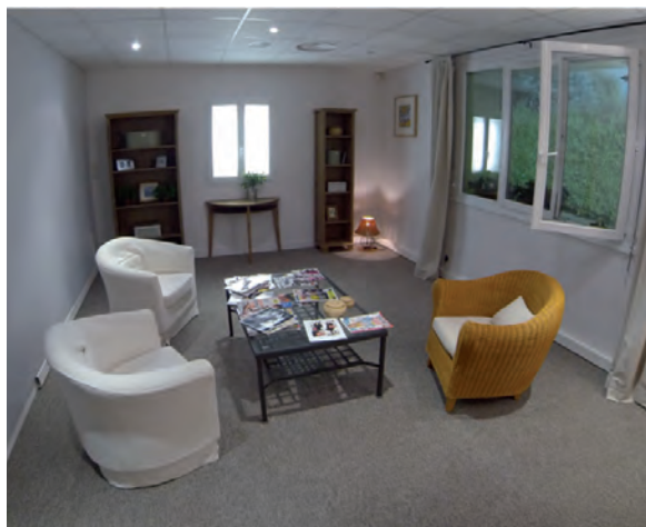
Fig. 2 : Photo du salon expérimental. Le bruit est diffusé derrière la fenêtre par seize haut-parleurs
