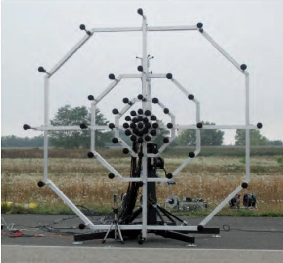
Fig. 4 : Antenne plane de 57 microphones (IFSTTAR)
