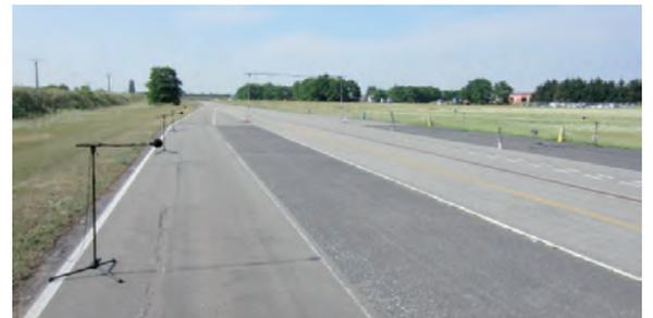
Fig. 3 : Mesure de bruit au passage par microphone à 7,5 m sur la piste IFSTTAR (Lyon)
