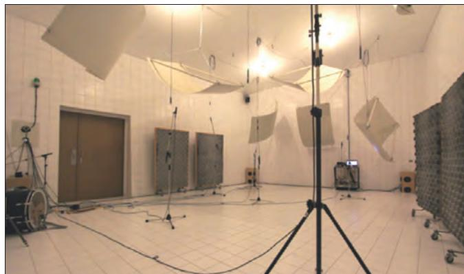
Fig. 4 : À gauche : représentation éclatée de la salle réverbérante et position des points de mesure ; à droite : photographie du dispositif expérimental (deux absorbeurs électroacoustiques peuvent être identifiés aux deux visibles sur l'image, désignés comme les coins C et D sur le plan de gauche)
