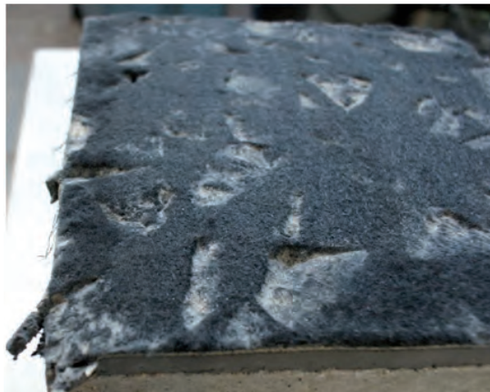
Fig. 8 : Empreintes de ballast sur des semelles sous traverses après tests de tenue dans le temps Ballast prints after on under sleeper pads after 1 million load cycles
