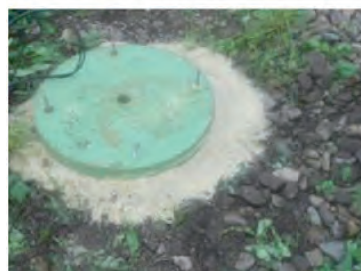
Fig. 4 : Mesure des fonctions de transfert entre la voie et le champ libre à proximité de la voie, impact au marteau sur la voie et sur un socle en acier en bord de voie Transfert functions measurement between the track and free-field, the track and the ground near to the track are loaded with hammer
