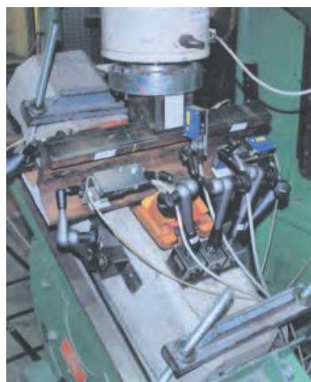
Fig. 7 : Test de systèmes d'attache DFC, à la résistance latérale du système par bielle inclinée Homologation tests for rail fastening system, measurement of lateral resistance with tilted rod
