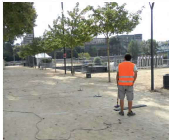
Fig. 3 : Mesure de décroissance vibratoire dans le sol Measurement of ground wave propagation for site characterization
