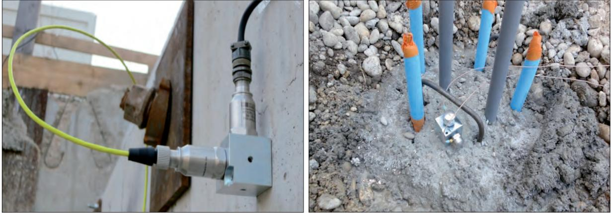
Fig. 10 : Vues des capteurs de vibration sur la murette de rehausse de la paroi pieux sécants, et en tête de pieu
