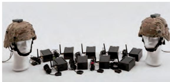
Fig. 3 : Détecteur acoustique (casques microphoniques et capteurs abandonnés)
