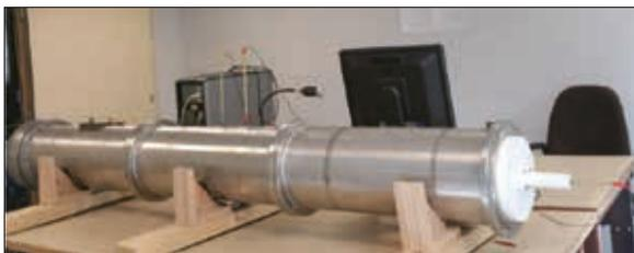
Fig. 2 : Tube d'impédance utilisé pour la caractérisation acoustique d'échantillons de feuillage et de substrat
