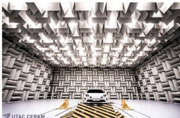
Fig. 14 : Nouvelle salle semi-anéchoïque de l'UTAC CERAM pour les essais *indoor*
