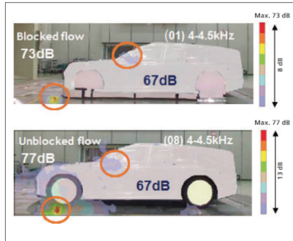
Fig. 6: Nécessité d'une plage dynamique d'au moins 13 dB pour pouvoir capter toutes les sources intéressantes
