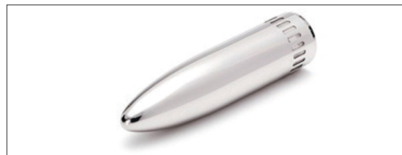
Fig. 3 : Cône G.R.A.S. qui peut être monté sur un microphone pour des mesures de pression dans un écoulement laminaire
