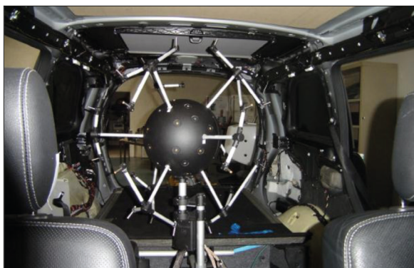
Fig. 18: Caméra acoustique 3D de LMS étendue pour améliorer les performances en basses fréquences
