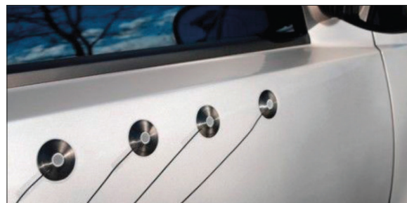
Fig. 4 : Microphones de surface G.R.A.S. servant à mesurer la distribution de la pression sonore en dehors de la soufflerie
