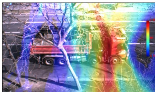
Fig. 11 : Antenne 128 voies pour la localisation des sources sonores routières (formation de voie). D'après [27] (Photos : R. Leiba, système MegaMicros - chaire Mouvie - UPMC)
