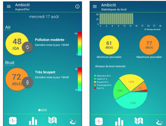
Fig. 1: Écran d'accueil d'Ambiciti avec la pollution atmosphérique locale et le bruit ambiant (à gauche), et les statistiques d'exposition (à droite).
