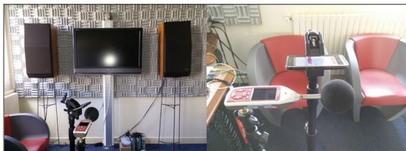
**Fig. 2 : Procédure d'étalonnage: le téléphone et un sonomètre sont placés en face d'enceintes qui émettent un bruit rose. Des mesures de 5 secondes sont prises à différentes intensités sonores pour estimer le biais du téléphone. Calibration procedure: the cellphone and sound level meter are placed in front of loud speakers that emit a pink noise. 5-second measurements are taken at different sound intensities in order to estimate the cellphone bias.**
