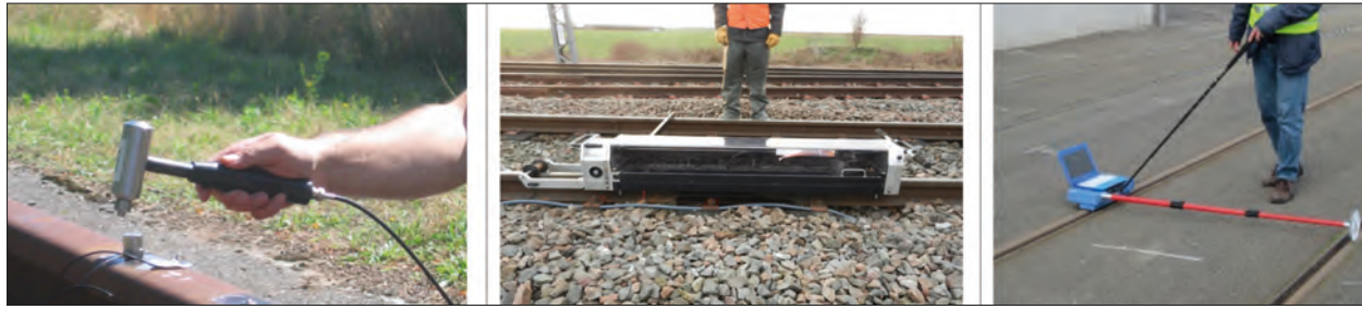
Fig. 3 : Mesure directe de TDR vertical selon EN 15461 (gauche). Mesure directe de rugosité rail selon EN 15610 ; règle de mesure fixe (centre) et chariot mobile (droite) Direct measurement of vertical TDR according to EN 15461 (left). Direct measurement of rail roughness according to EN 15610; using a ruler (centre) and a trolley (right)
