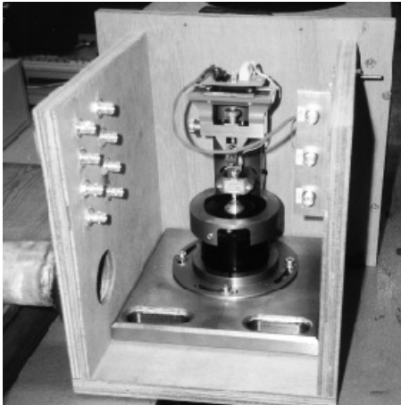
Fig.4 : Vue du prototype de G.A.C qui a été développé. On peut y apercevoir la vanne dont la surface de passage est modulée en amplitude grâce au vibreur électrodynamique. L'ensemble du dispositif est placé dans une boîte hermétique (de volume égal à quelques dm 3 ), qui joue le rôle de chambre de compression. Cette chambre est alimentée via une bonbonne d'air sec comprimé. Le tuyau d'alimentation est visible en bas à gauche.
