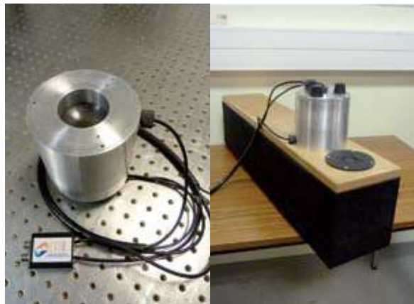
Fig. 2 : Vue du capteur doté de son électronique (à gauche) et application à la mesure de l'impédance d'une enceinte acoustique (à droite) View of the impedance sensor (left) and its application to loudspeaker enclosure design (right)
