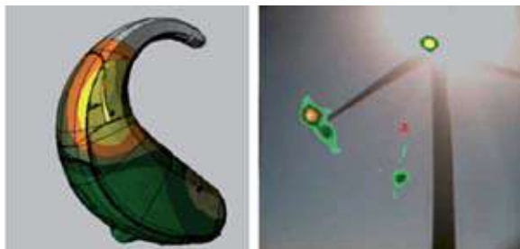
Fig. 11 : Left: Conformal sound intensity map on a hearing aid at 2 400 Hz. Right: refined beamforming sound intensity map on wind turbine at 4 000 Hz Gauche : Carte d'intensité sonore conforme sur une aide acoustique à 2 400 Hz. Droite : Carte d'intensité sonore d'une éolienne à partir d'une méthode fine de faisceaux à 4 000 Hz
