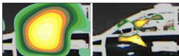
Fig. 5: Sound Intensity maps based on beamforming measurements in a wind tunnel. Left: delay and sum method. Right: Refined beamforming method Cartes d'intensités sonores basées que les mesures de faisceaux dans une soufflerie. A gauche : méthodes de retard et de sommation. A droite : méthode pure des faisceaux
