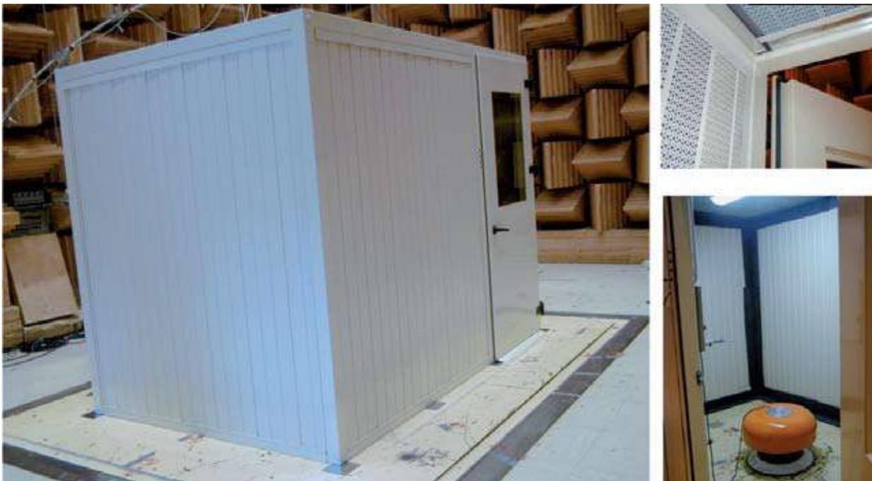
Fig. 1 : Photographie d'un des encoffrements installé en chambre sourde avec vues de détail des matériaux intérieurs et de la source utilisée
